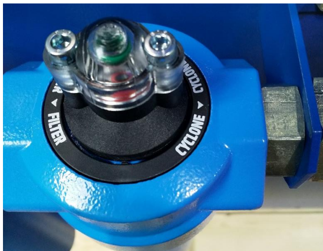
Рисунок 3 – Направление потока сжатого воздуха в фильтре сжатого воздуха
