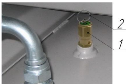
Рисунок 9 – Клапан предохранительный пружинного типа
